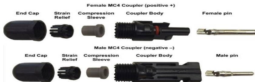
Figura 59. Arquitectura de los conectores MC-4. Recuperado de: MCCEEA, Catálogo, 2017, https://cceeaa.mx/blog/energia-solar-fotovoltaica/conectores-mc4
