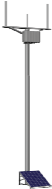
Figura 55. BTS alimentado por medio de un panel fotovoltaico.
