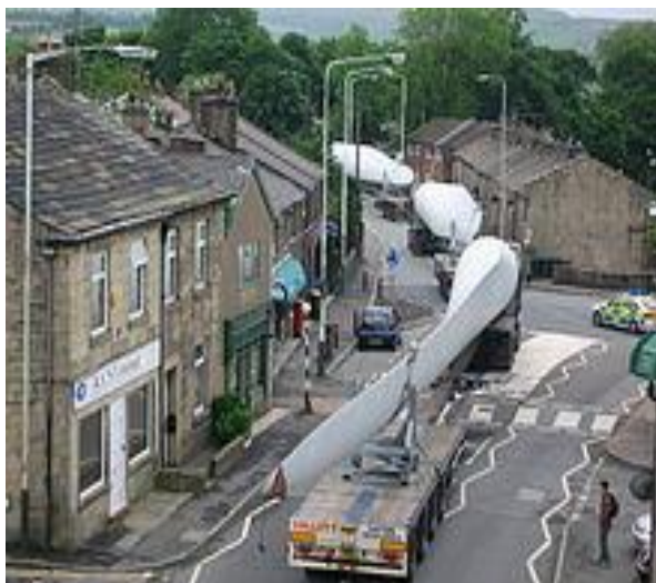
Figura 33. Transporte de aerogeneradores, 2007
