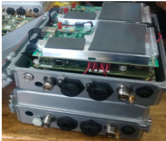
Figura 56. BTS que se usará en Villa Talea de Castro.
