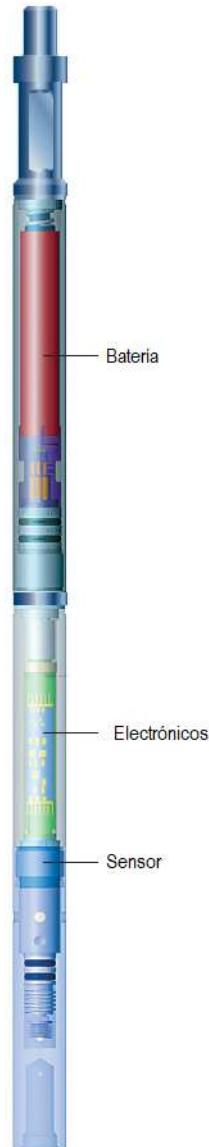
Fig. IV.2.4.4 Esquema de la sonda Signature CQG , ( Schlumberger ).
