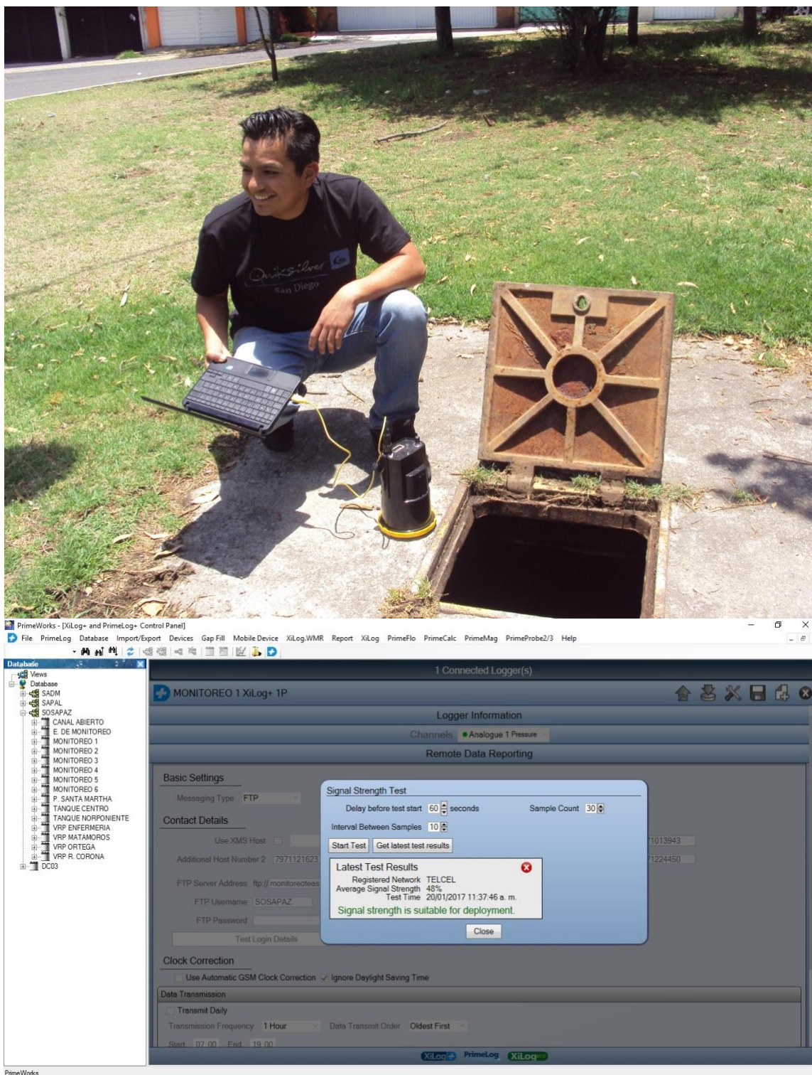
Ilustración 25. Pruebas de transmisión, Programación (arriba), Resultado (abajo).
