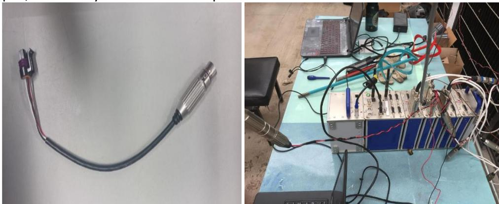
3.13 Conector tipo CANON y sistema de adquisición de datos marca imc modelo CRONOSflex
