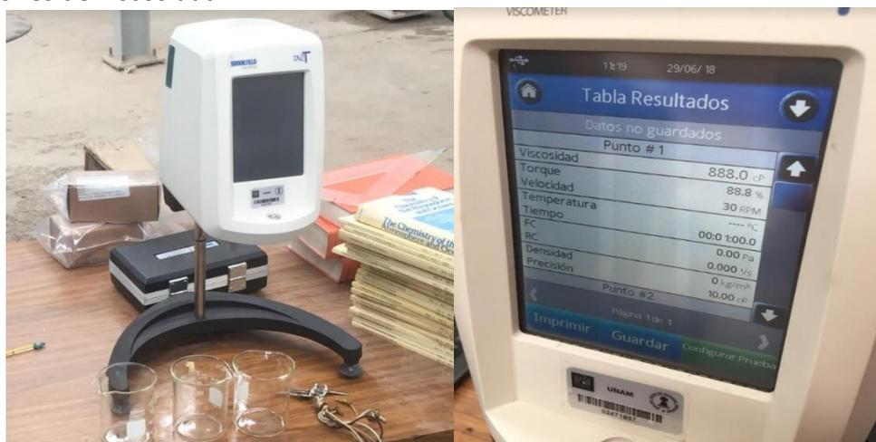
3.10 Medición de viscosidad glicerina, con viscosímetro por efecto Couette, marca Brookfield
