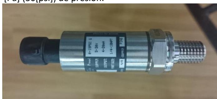
3.11 Transductor de Presión manométrico, modelo MEAS U5300.
