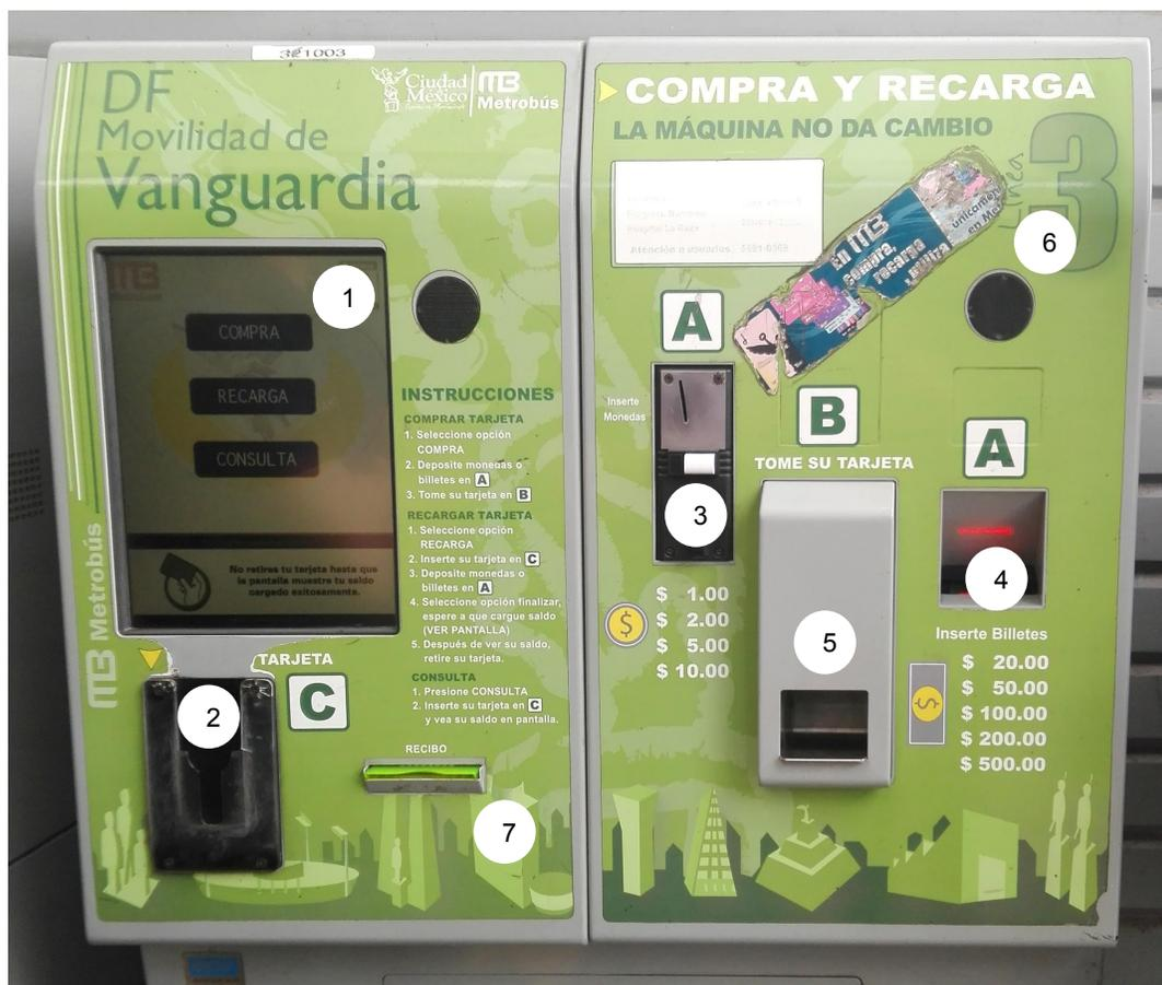
Figura 2.8. TVM completa de la Línea 3 del Metrobús de la CDMX.
