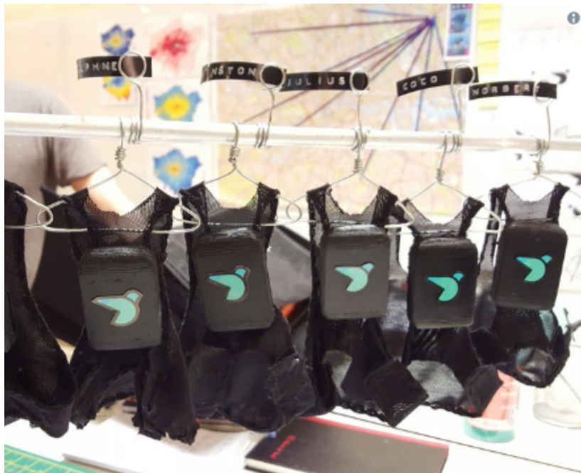
Imagen 3. Mochilas de monitoreo de calidad del aire usadas por palomas en Londres. 5
