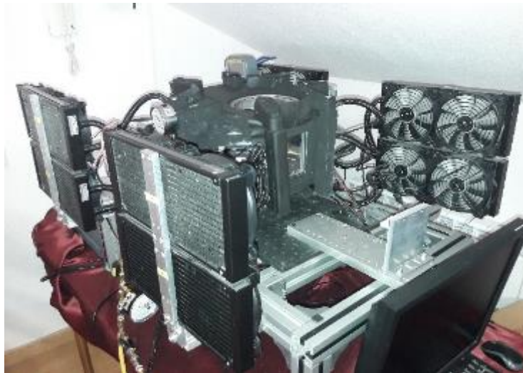
Figura 1.2 Cámara climática diseñada por MAG SOAR.
