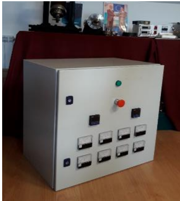
Figura 4.5 Apariencia del nuevo sistema de alimentación finalizado.
