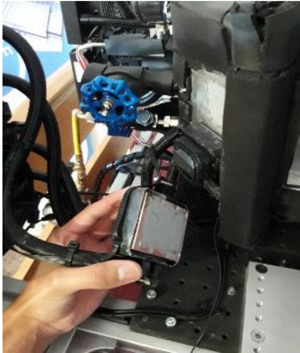
Figura 3.39 Desmontaje de la bomba para cambiar las células Peltier.
