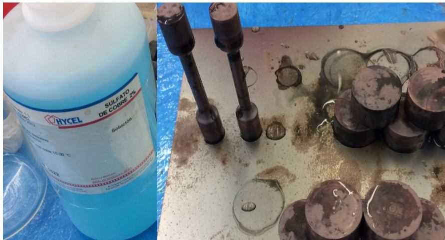
Figura 4.5. Solución de sulfato de Cu al 2% y probetas expuestas con la capa de Cu formada.
