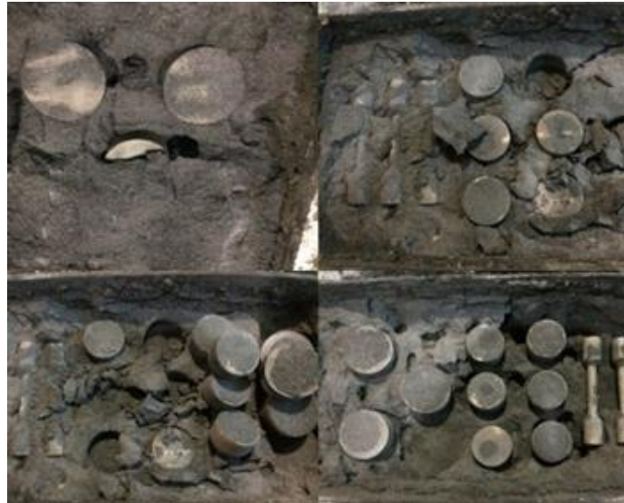
Figura 4.3. Secuencia de extracción de las muestras y probetas tras el borurado.
