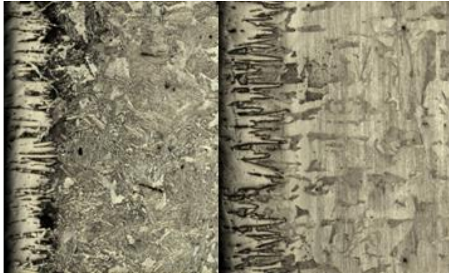
Figura 2.7. Acero SAE 4140 y 1018 capa borada, respectivamente, observado a 100x.
