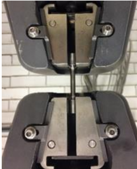
Figura 4.7. Prueba de tracción en acero SAE 1018.
