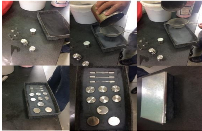
Figura 4.2. Secuencia de preparación de la caja para borurar.
