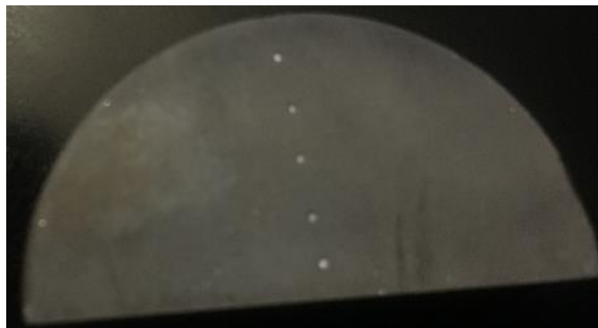
Figura 4.8. Disposición de indentación para los ensayos de dureza.
