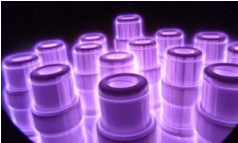
Figura 4.6. Ejemplo de nitruración por plasma. [15]
