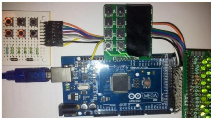
Figura 47. Prototipo de RTU con placa Arduino.
