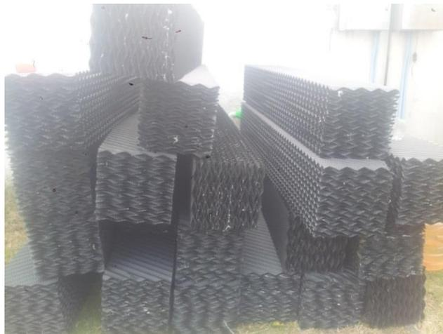
Figura 67. Instalación de bio-película para tratamiento de aguas.
