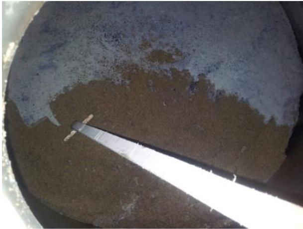
Figura 60. Verificación del estado de un filtro de arena. Se observa la capa de materia retenida por el filtro.
