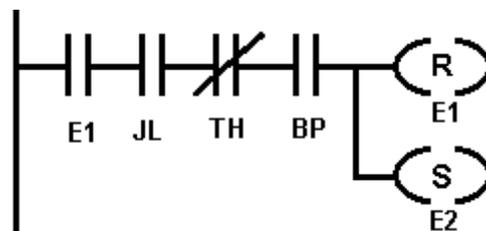
Figura 36. Escalón equivalente al termino obtenido.
