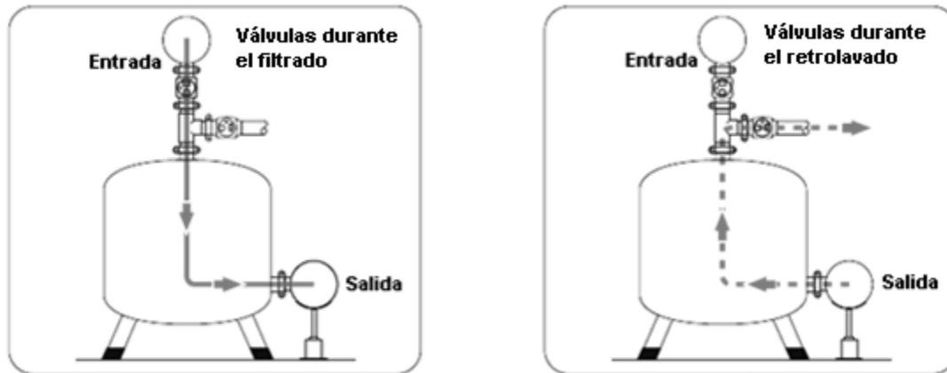
Figura 30. Cambio del flujo de agua durante la limpieza de un filtro. [18]
