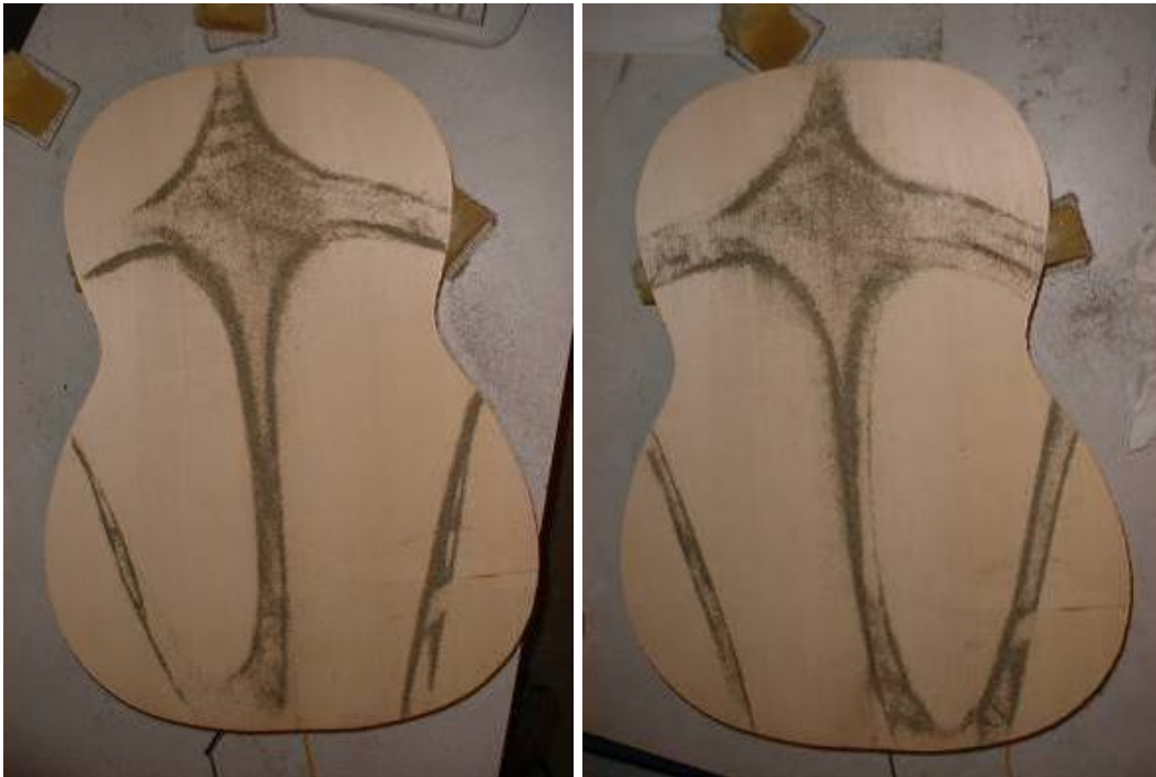
Figura 26. Diferencias en el modo de vibración libre presentado a 108 \pm 0,5 \text{ Hz} , variando el punto de excitación a la izquierda y a la derecha del eje de simetría de la tapa.
