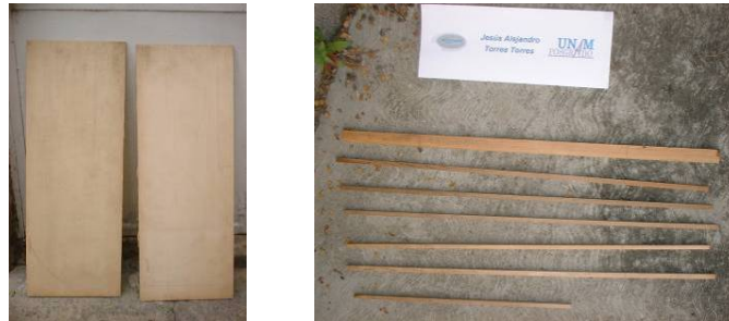
Figura 7. Maderas para la construcción. Dos placas simétricas para la construcción de la tapa (izquierda); y seis varas para el abanico y una viga trapezoidal para las barras de la boca (derecha).
