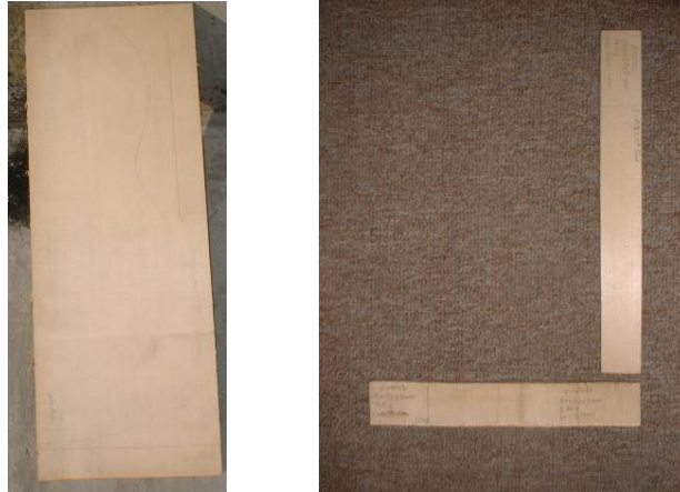
Figura 9. Trazado del contorno de la tapa y las vigas (izquierda), y vigas utilizadas como probetas (derecha).
