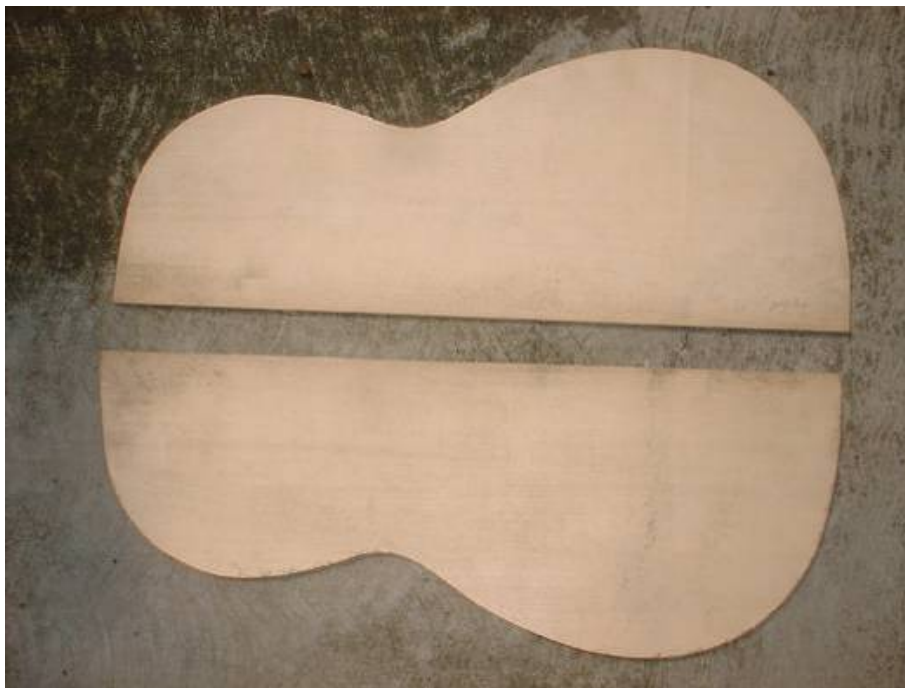
Figura 19. Placas cortadas con geometría aproximada a cada mitad de la tapa superior.
