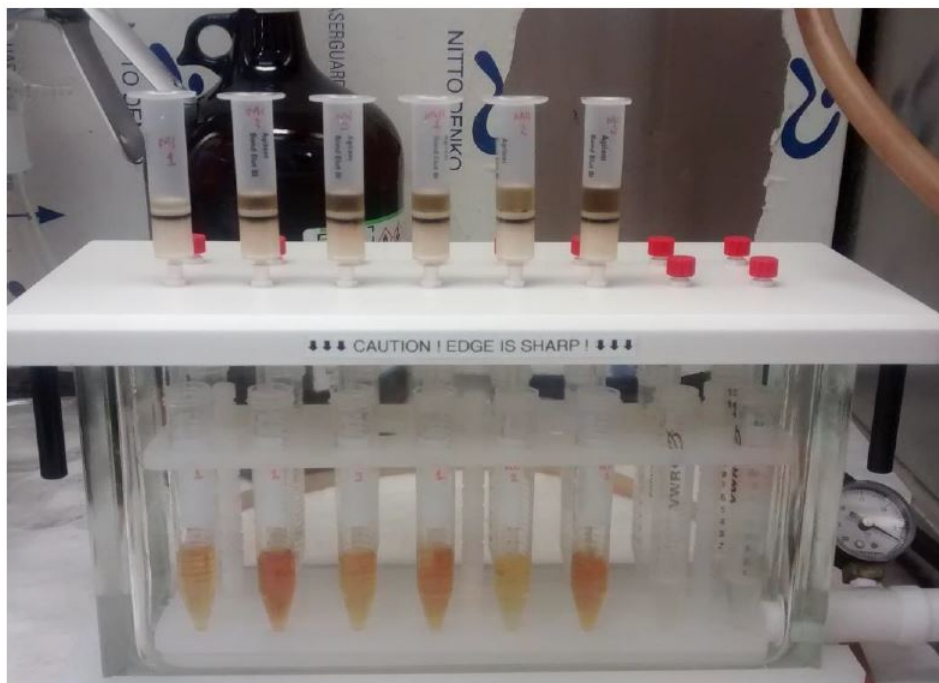
Figura B.5: Purificación de las muestras derivatizadas por SPE-Sílica con Hexano: DMC (6 : 4).
