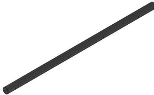
Figura 4.16: Tubo de ABS 32 (mm) de diámetro y 85 (cm) de largo.
