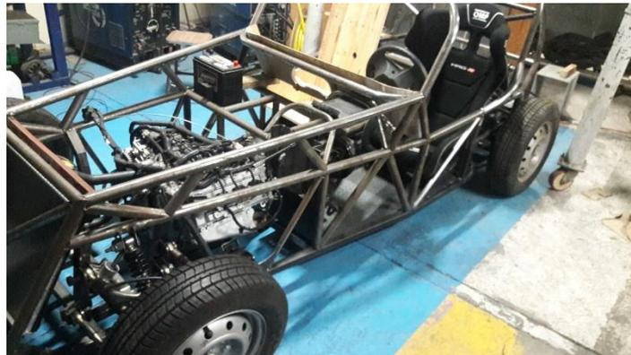
*Figura 8 Ejemplo de chasis tubular (cortesía del CDMIT)*
