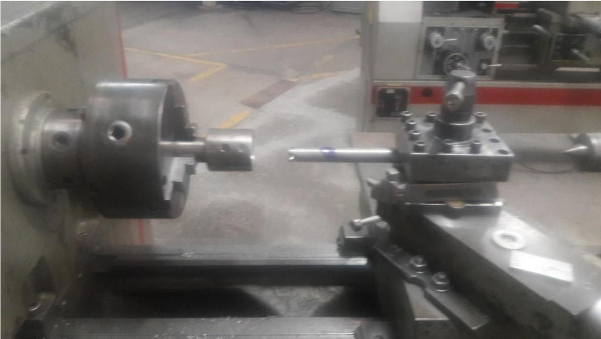
*Figura 58 Maquinado del barreno de 1 1/2 [pulg].*
