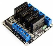
*Figura 79 Relevador de estado sólido 4 canales G3MB-202P.*
