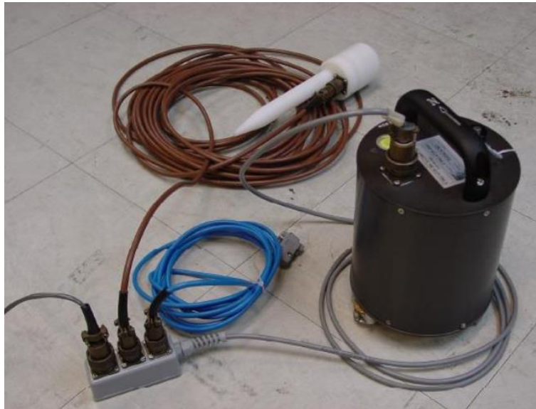
Figura 19 - Sismómetro triaxial de banda ancha CMG-6TD de Guralp, utilizado por el Instituto de Ingeniería con sus respectivos cables, conexiones y GPS (Blanco), conectados a una batería de 12v.
