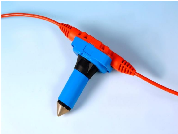
Figura 20 - Acelerómetro digital DSU3-428XL de Sercel utilizado por la empresa externa.
