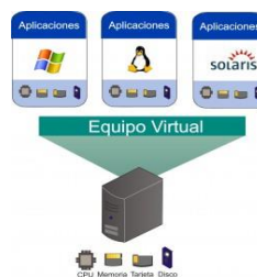
Figura 4.1. Virtualización de tres sistemas operativos diferentes compartiendo hardware del sistema anfitrión.
