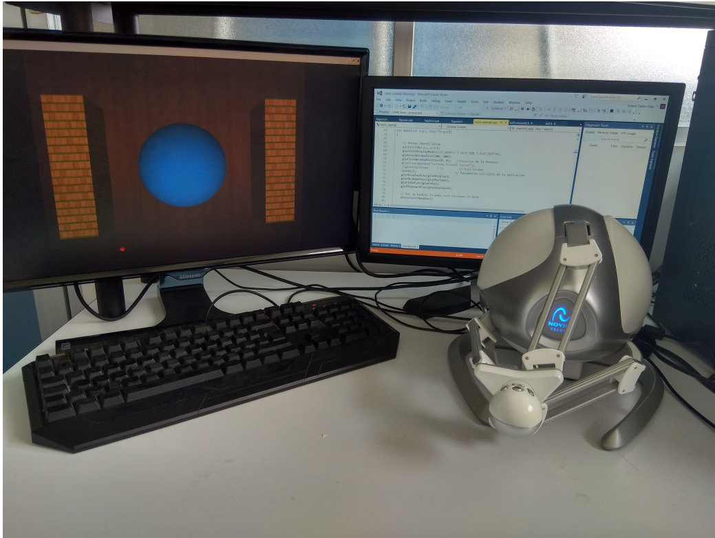
Figura 4.5: Sistema de realidad virtual con interacción háptica para objetos rígidos utilizando el robot Novint Falcon .
