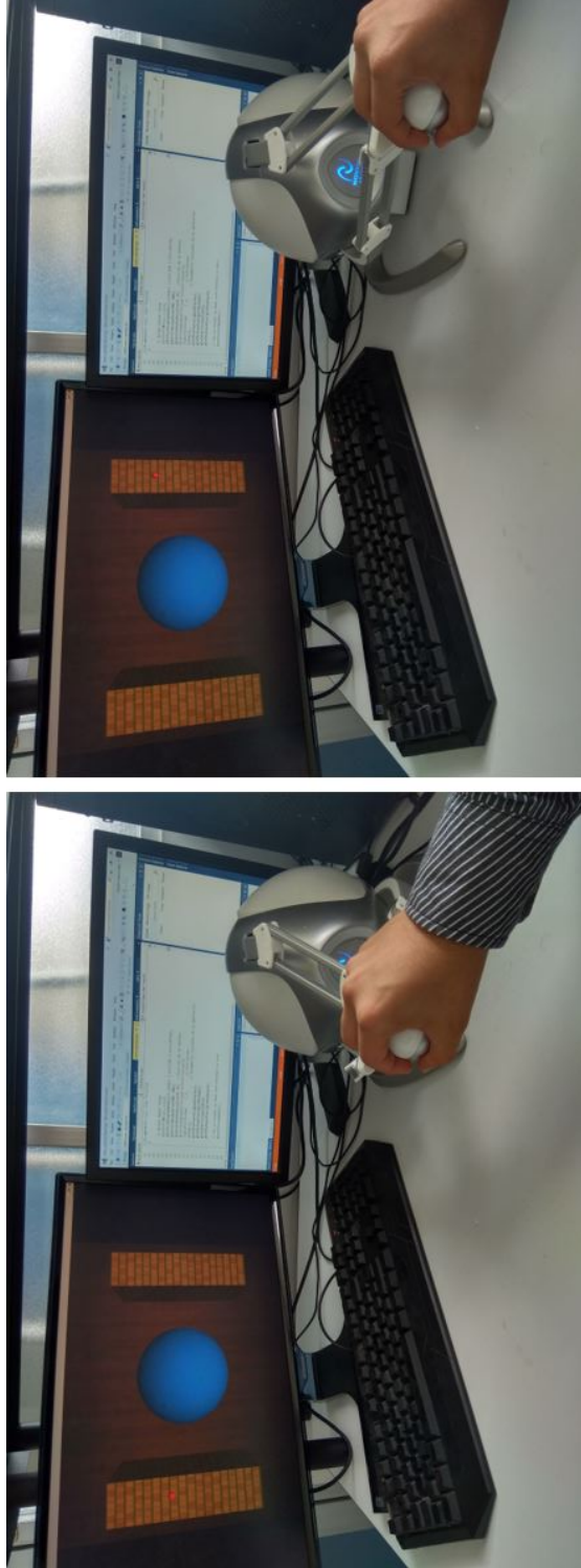
Figura 4.7: Interacción con objetos rígidos texturizados utilizando el dispositivo Novint Falcon.
