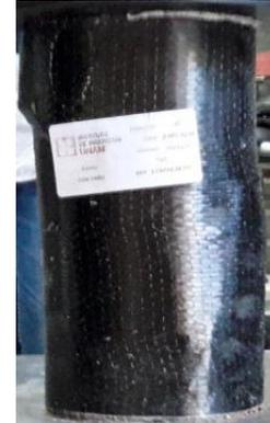
c) Falla a compresión del cilindro
