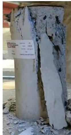
b) Falla a compresión del cilindro
