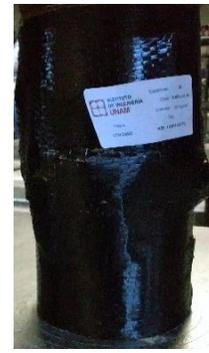
c) Falla a compresión del cilindro
