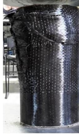
b) Falla a compresión del cilindro
