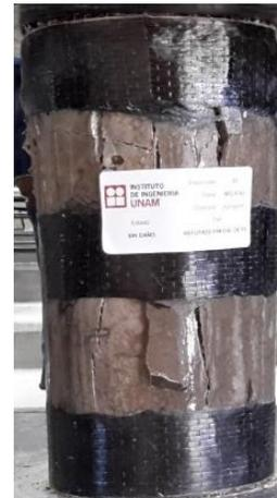
b) Falla a compresión del cilindro
