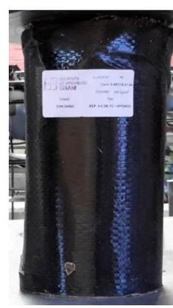
c) Falla a compresión del cilindro
