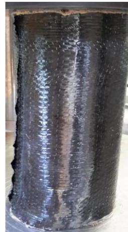
b) Falla a compresión del cilindro
