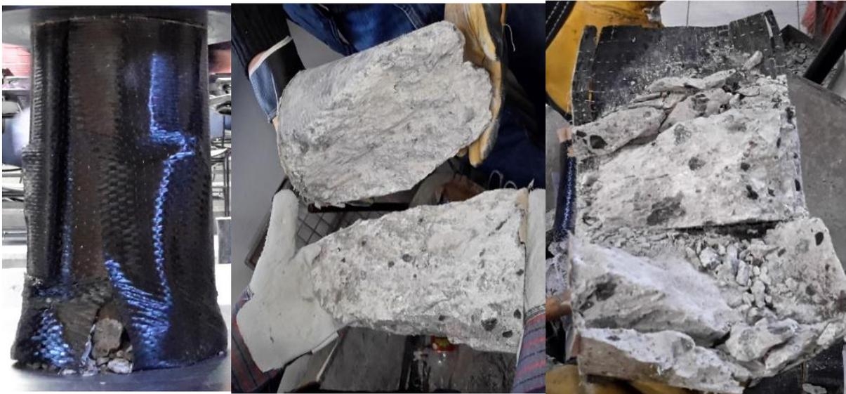
**Figura 3.14. Falla de cilindros sometidos a carga axial**
