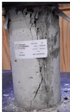
b) Falla a compresión del cilindro
