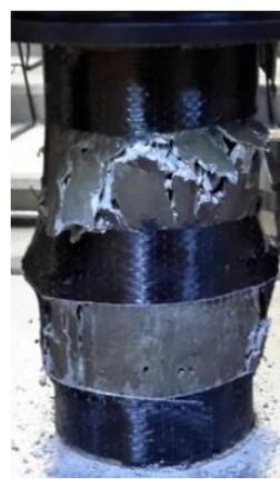
b) Falla a compresión del cilindro
