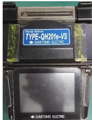
Figura 1.11. Empalmadora de fusión con alineamiento por revestimiento activo
