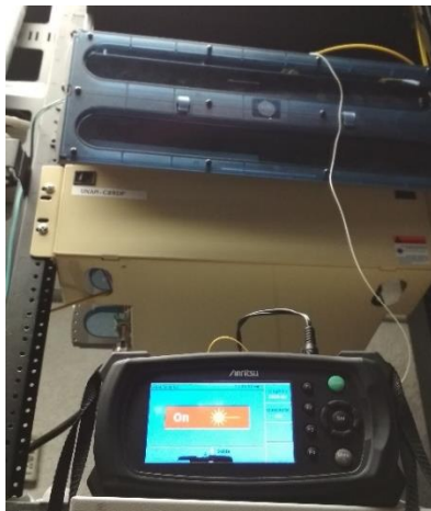
Figura 2.7. Conexión de fuente de luz al enlace.
