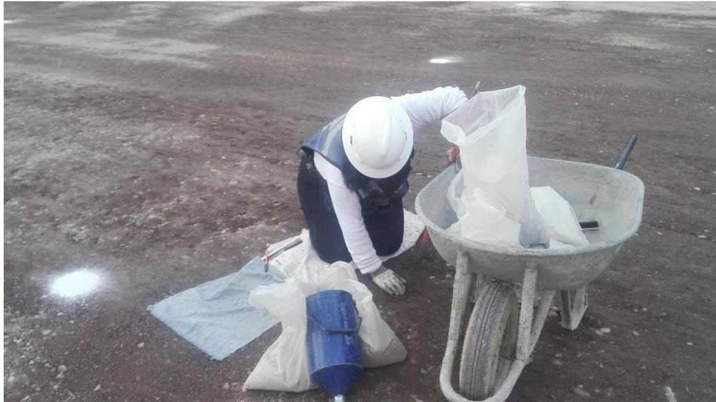
Figura 3-37 Laboratorio realizando calas en la terracería
