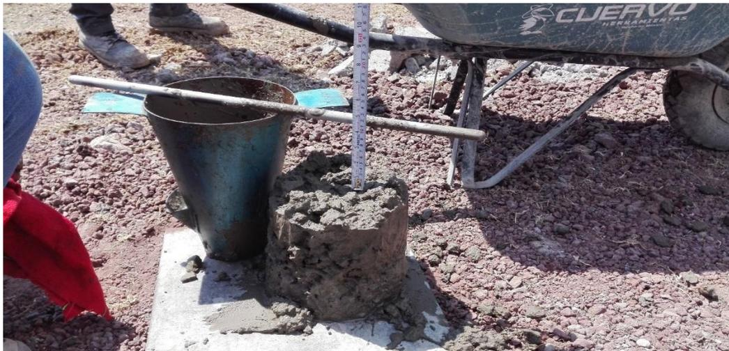
Figura 3-12. Prueba de Revenimiento
