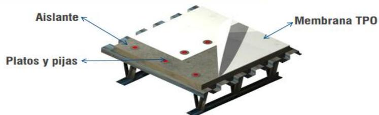
Figura 3-25 Sección Típica de impermeabilización
