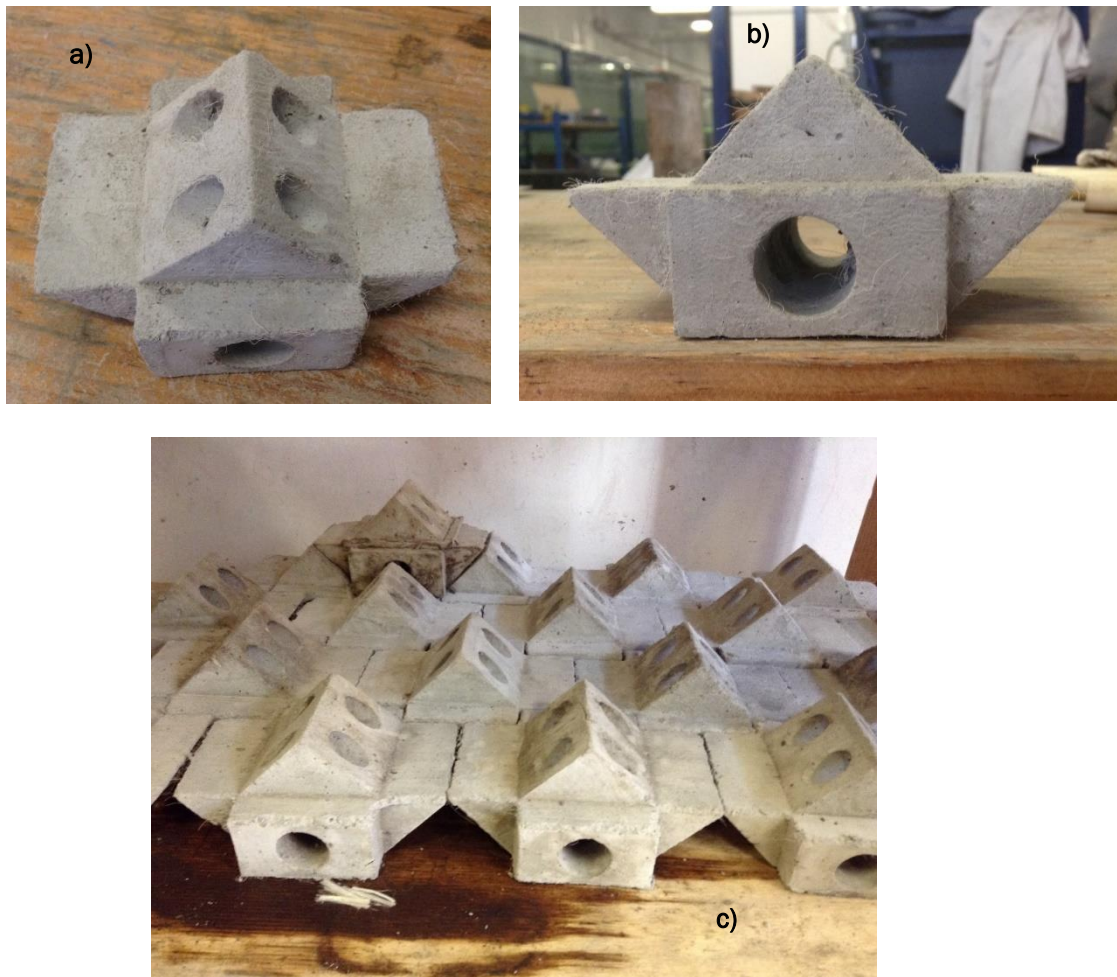
Figura 29 – Detalle de pieza de producción: a) Vista superior b) Vista lateral c) Armado del dique
