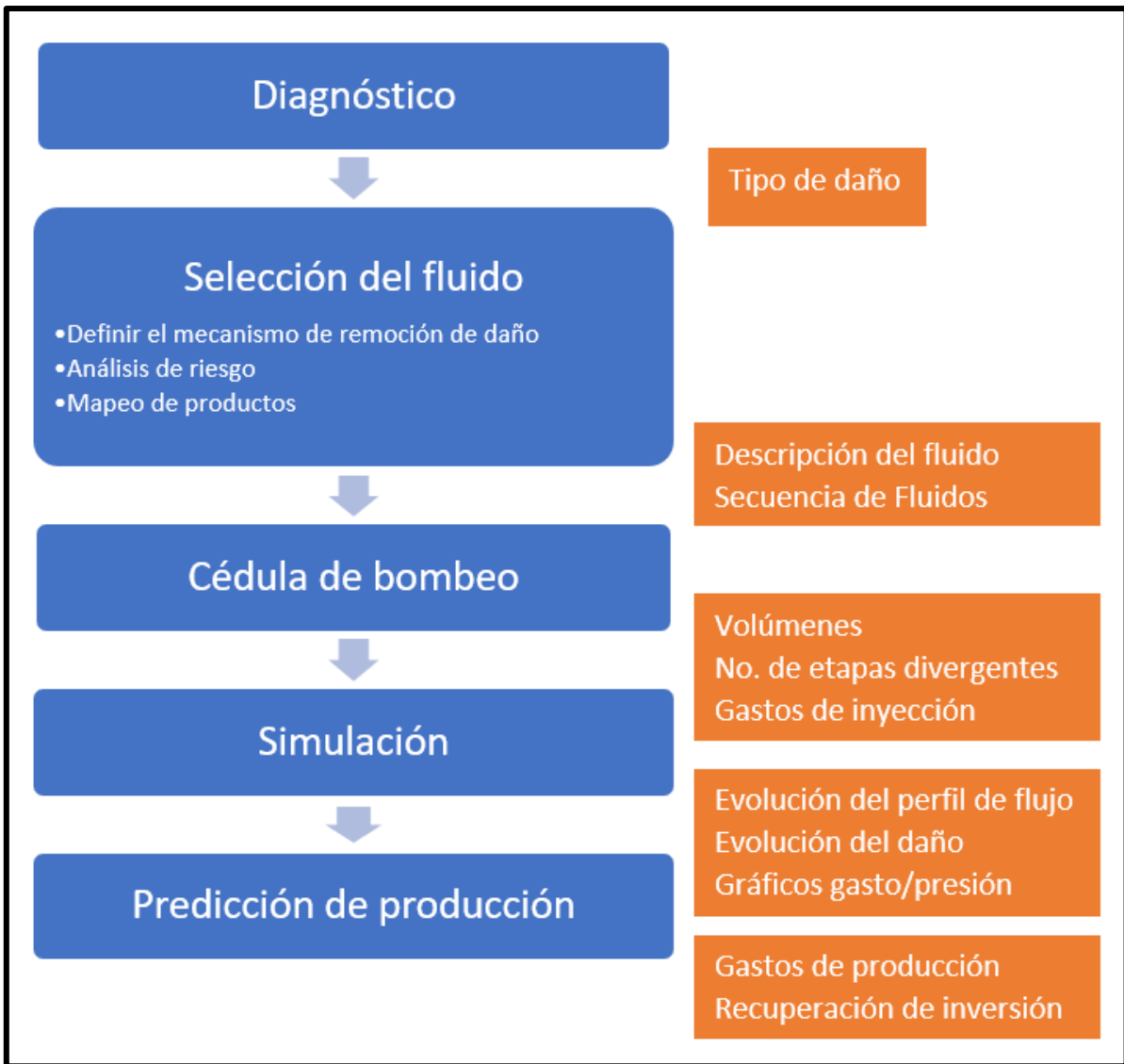
Figura 3.3 Cinco pasos esenciales en el diseño de una estimulación matricial considerados en el software ProMAT de Schlumberger (Modificada de Crowe, Masmonteil y Thomas, 1992).
