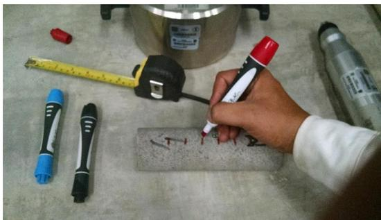
Figura 6.8 Las marcas o puntos de impacto pueden o no seguir un orden, sólo se deberá cumplir con el requerimiento de separación entre ellos.
