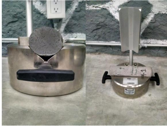
Figura 6.9 Base de metal con ranura en v y soporte para martillo Schmidt
