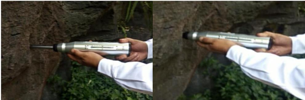
Figura 5.7 Toma de datos con el martillo Schmidt en una pared de discontinuidades
