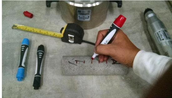
Figura 5.2 las marcas o puntos de impacto pueden o no seguir un orden, sólo se deberá cumplir con el requerimiento de separación entre ellos.
