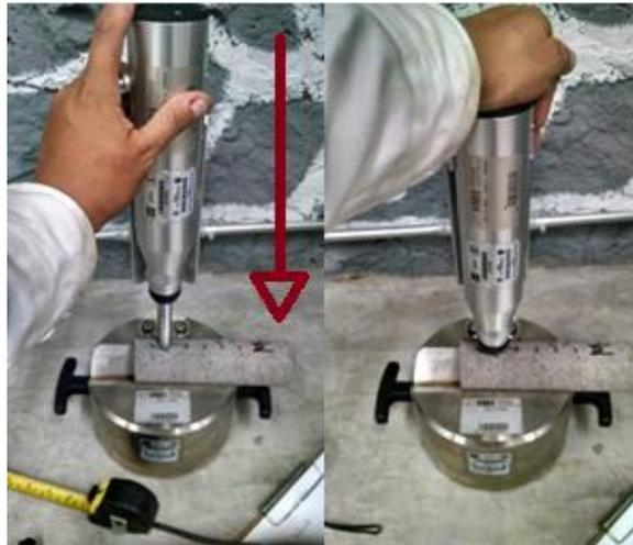
Figura 5.6 martillo Schmidt registro de datos del ensayo de valor de rebote
