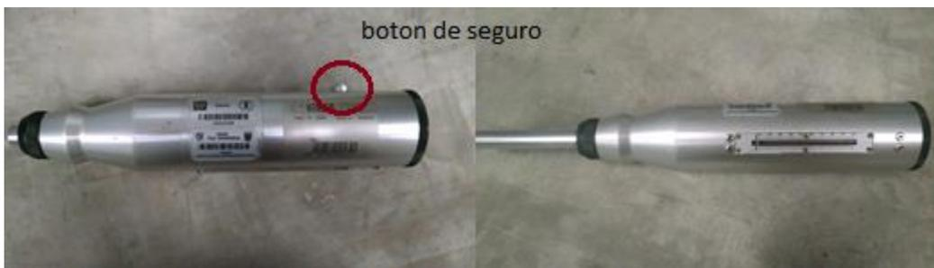
Figura 5.5 martillo Schmidt en posición de cargado y en posición liberado de inicio para la toma de datos
