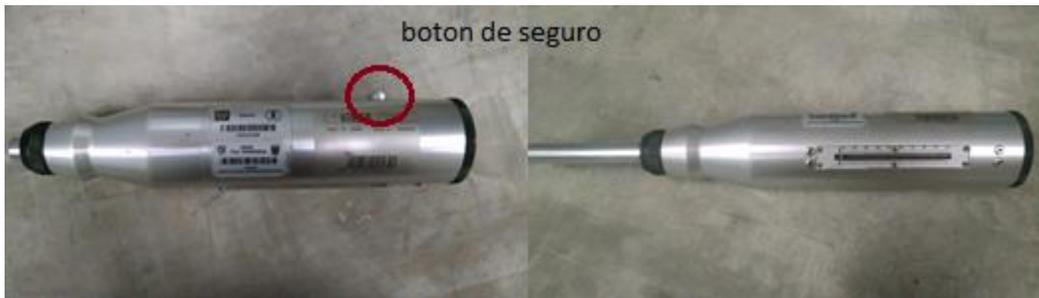
Figura 6.7 Martillo Schmidt en posición de cargado y en posición liberado de inicio para la toma de datos
