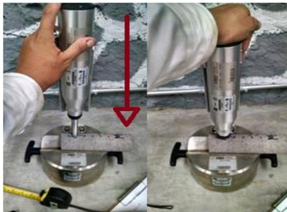
Figura 6.10 Martillo Schmidt registro de datos del ensayo de valor de rebote
