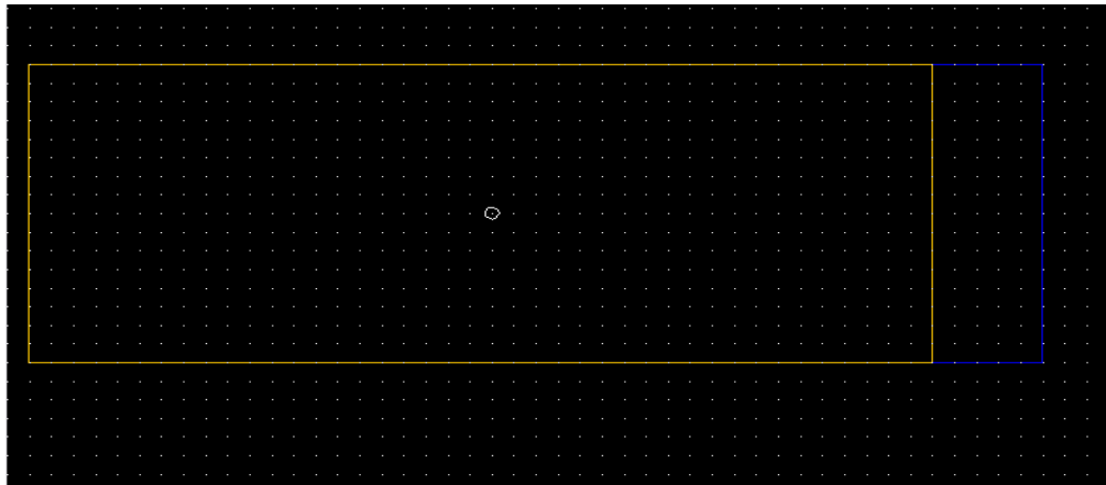
Figura 5.7 Mascara m1 para definir el anclaje de los microcantilevers.
