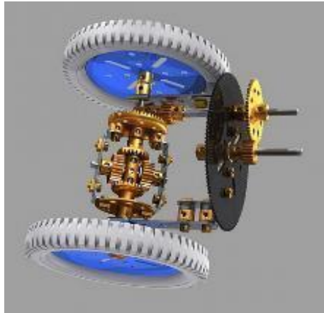
Ilustración 12 Transmisión de movimiento por medio de engranes [I12].
