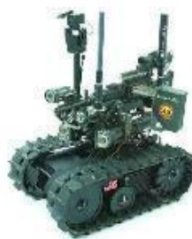
Ilustración 18 Robot con sistema de desplazamiento mediante orugas [18].
