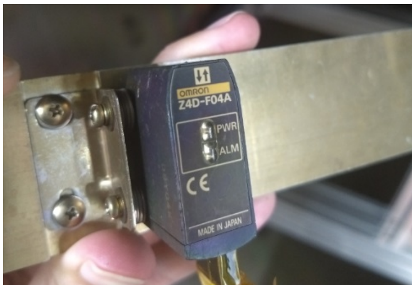
Figura 7.13: Sensor de posicionamiento OMRON Z4D-F04A utilizado en el sistema de medición de empuje del Laboratorio Komurasaki-Koizumi.
