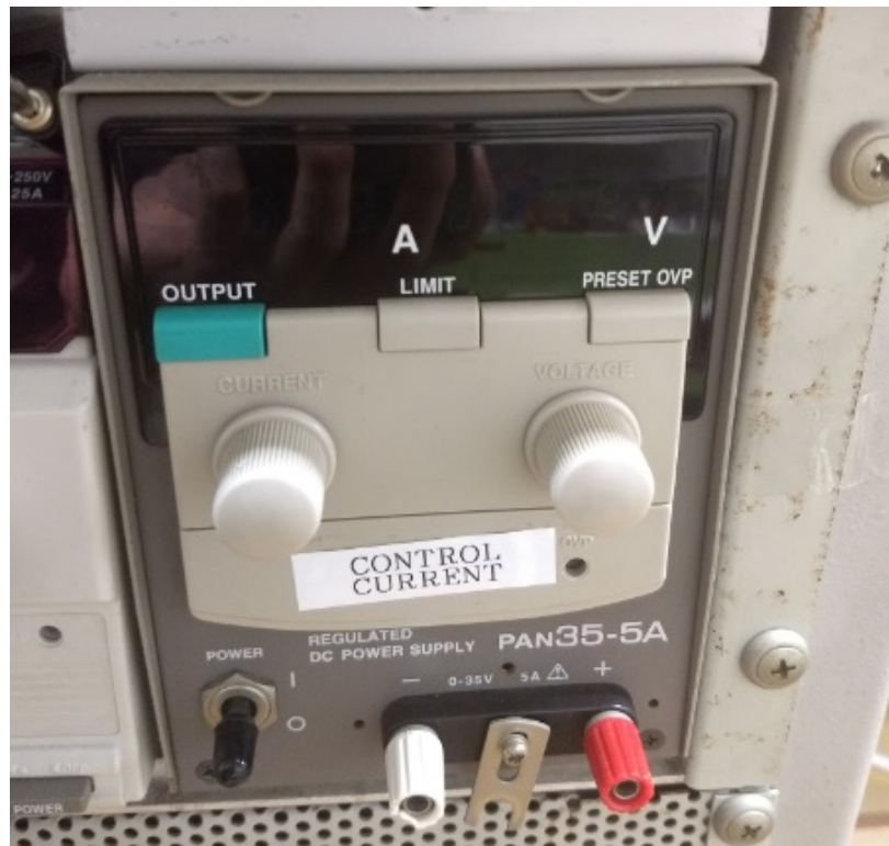
Figura 7.28: Fuente de voltaje KIKUSUI PAN35-5A utilizada en el Laboratorio Komurasaki-Koizumi.
