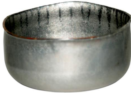
Figura 4.1 “Arrugas” en el interior de la copa de chapa recocida calibre 20.
