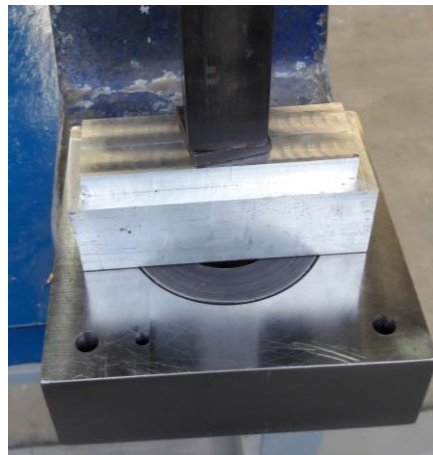
Figura 2.10 Ensamble con ajuste medio.
