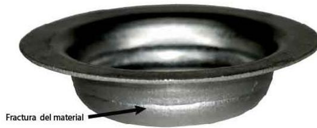
Figura 3.2 Fractura de calibre 18 recocido
