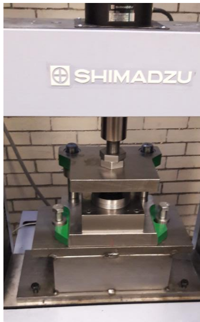
Figura 2.19 Troquel de embutido en máquina de ensayos universal.
