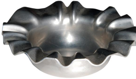
Figura 1.7 Pliegues formados por falta de fuerza en el pisador “arrugas”.
