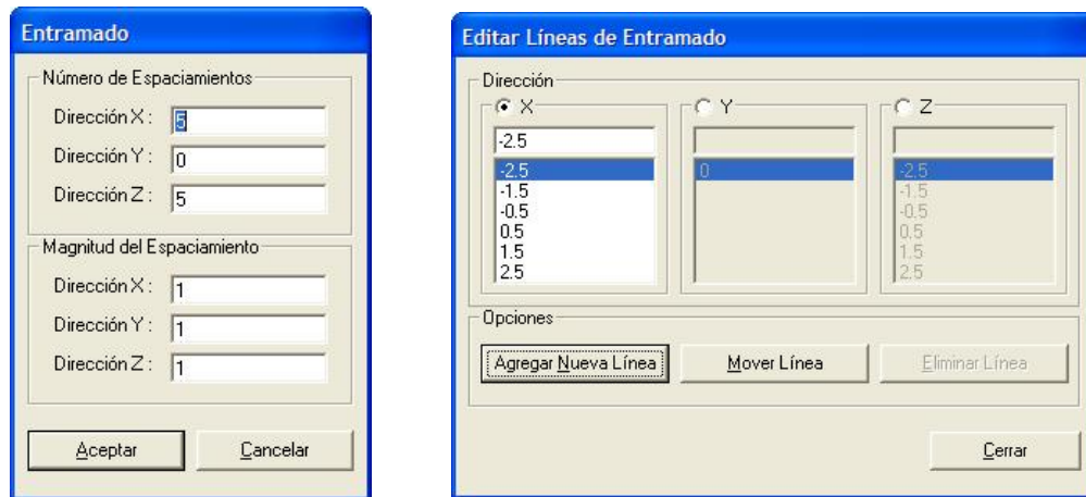
Figura IV.82 Interfaces de usuario par edición, consulta, selección y asignación de los parámetros que definen la configuración de entramado o mallado del modelo estructural de elemento finito tipo barra, implantado en el sistema computacional de análisis y diseño de cimentaciones ParWin .
