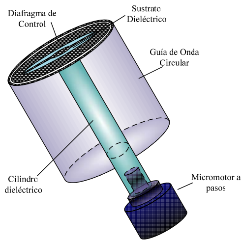
Figura 2.18 Estructura propuesta para el desplazador de fase reflectivo
