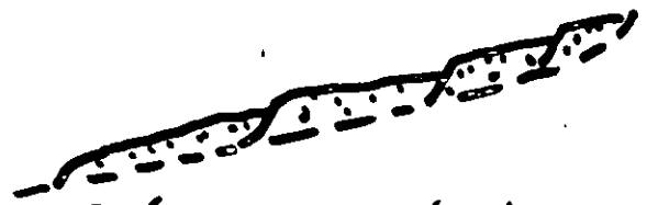
Falla regresiva traslacional
