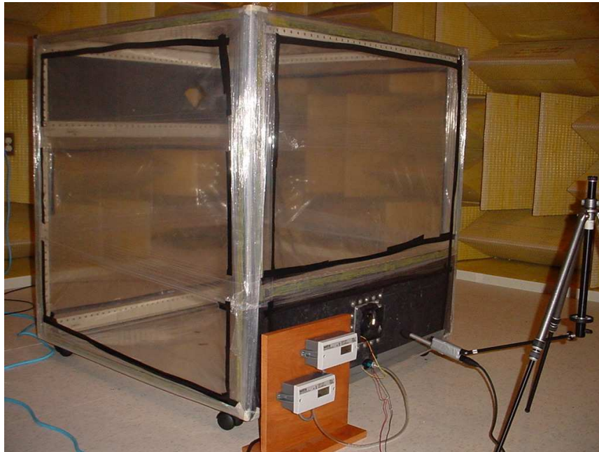
Figura 3.3: Configuración para el registro del ruido dentro de la Cámara Semi-Anecoica.
