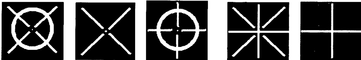
Aspecto de diversas marcas fiduciales dependiendo el tipo de cámara.
