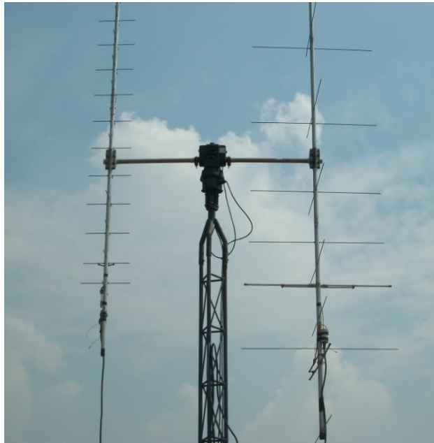
Figura 6.3 Brazo de fibra de vidrio que sostiene en cada extremo un arreglo de antenas con sus balun.
