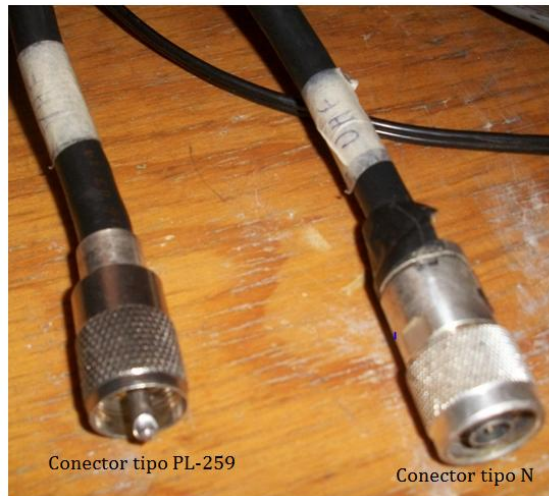
Figura 6.4 Conectores para las antenas VHF y UHF.
