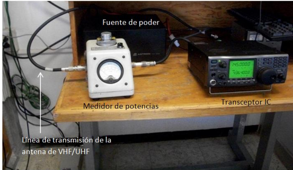
Figura 6.18 Conexión para medición de Onda Estacionaria.
