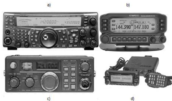
Figura 4.10 Imágenes de equipos transceptores: a) Kenwood TS-2000, b) Kenwood TM-D710, c) Yaesu FT-290R, d) ICOM IC-2820.
