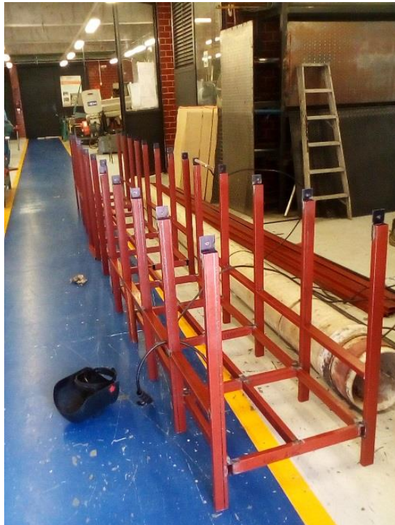
Figura 6 Fabricación del esqueleto de acero
