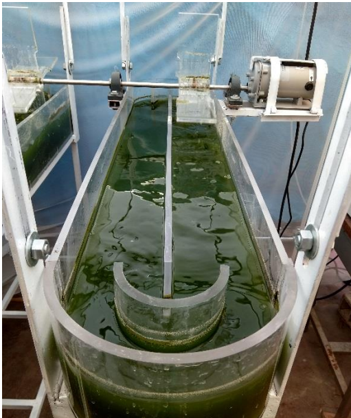
Figura 1 Reactor, sistema abierto tipo raceway hecho de lámina de acrílico
