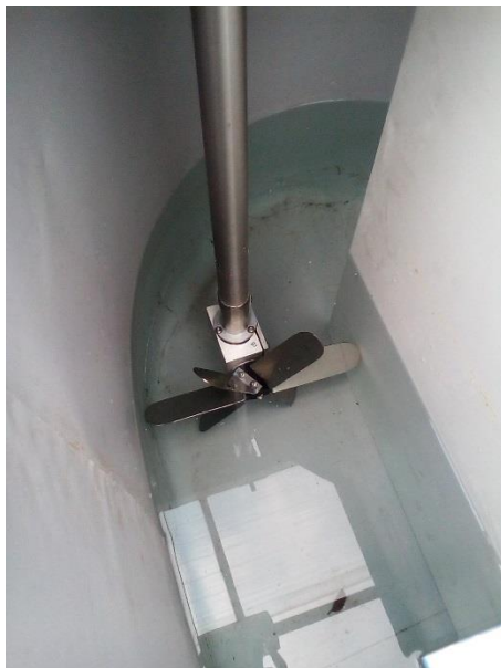
Figura 14 Sistema de mezclado con hélice (elaboración propia)
