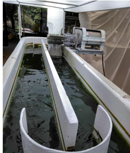
Figura 2 Reactor, sistema abierto tipo raceway hecho de fibra de vidrio
