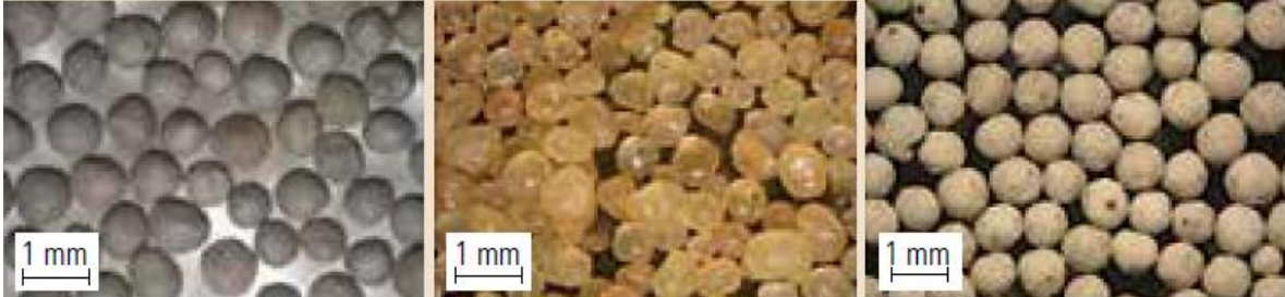
Ilustración 2-10 Apuntalantes. Bauxita de alta resistencia(izquierda), sílice recubierto con resina(centro) y cerámica liviana(derecha) (Nolen-Hoeksema, 2013).
