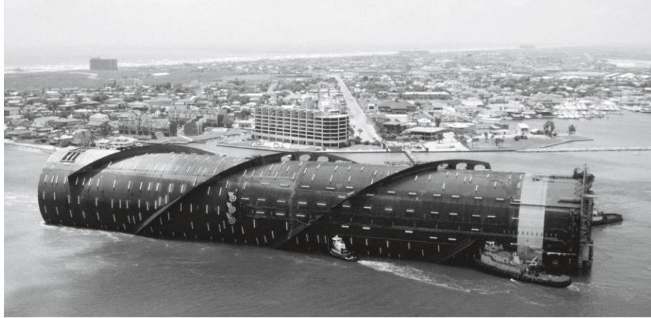
Figura 2.9 Plataforma spar remolcada (Leffler et al., 2011)
