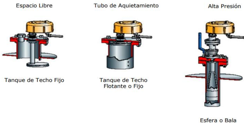
Fig. 18 Ejemplo de Medición por Radar
