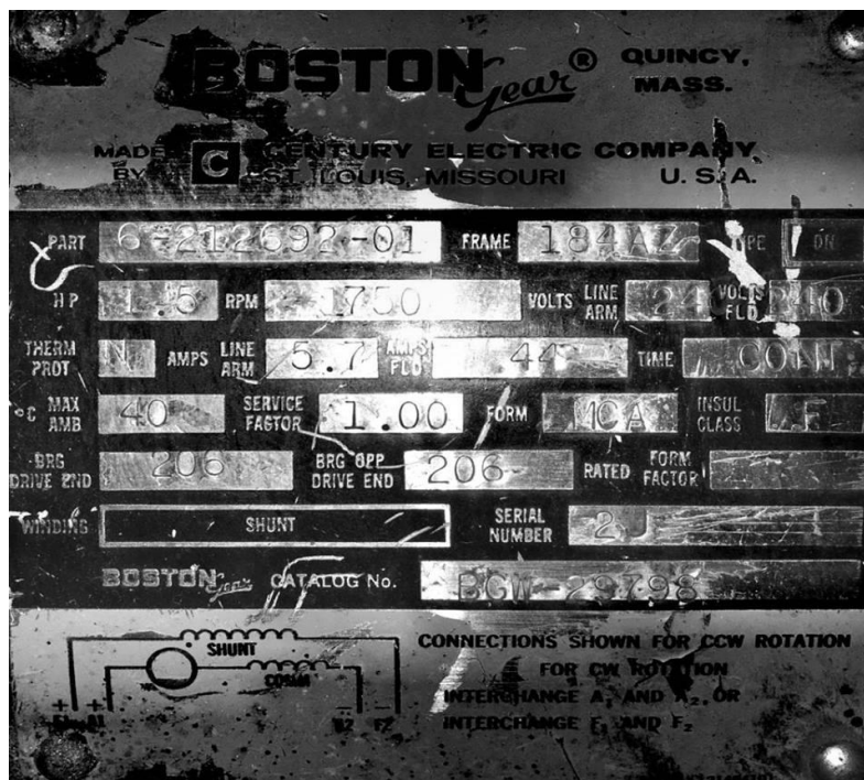
Imagen 8. Placa de identificación del motor DC.
