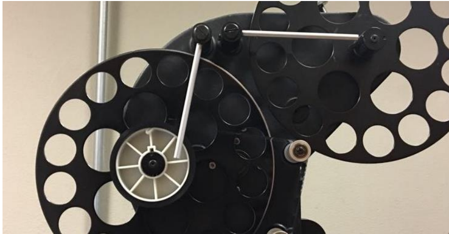
Imagen 30. Seguro dañado en su posición de seguridad horizontal.
