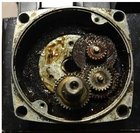
Imagen 27. Tren de engranes reductores de velocidad.
