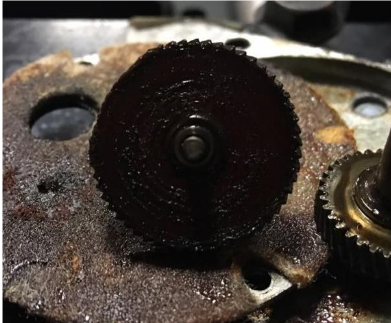
Imagen 28. Engrane inferior dañado.
