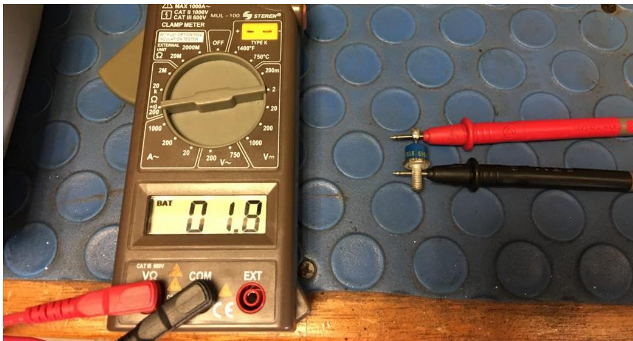
Imagen 12. Diodo polarizado en directa, con el ánodo en la parte superior.
