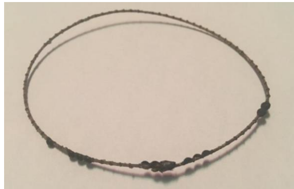
Imagen 35. Banda dentada completamente dañada.
