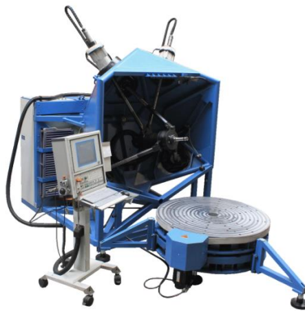
Figura 2.8. PM800 con mesa redonda móvil [8].
