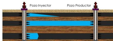
Figura 2.2.4.1: Configuración de Pozo Inyector y Pozo Productor [13]
