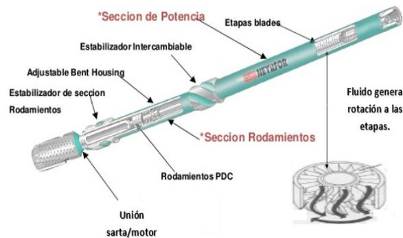
Figura 3.1.0.1: Partes de un motor de fondo de turbina [42]
