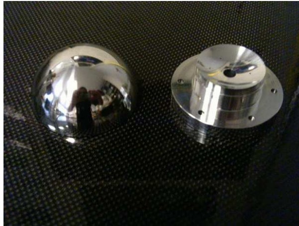
Figura 3.3 Semiesfera y copa, piezas de un cojinete neumático esférico.
