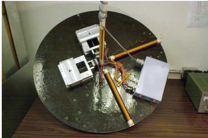
Figura 3.14 Ubicación de las bobinas en la plataforma de simulación.
