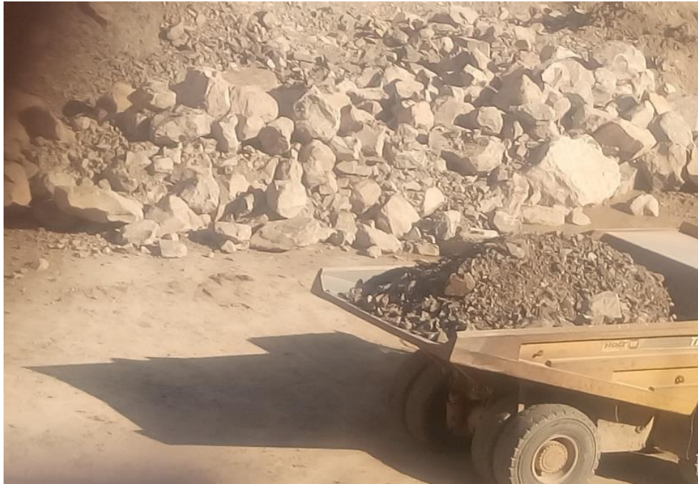
Figura 6. Rocas de sobre tamaño de voladuras anteriores al proyecto
