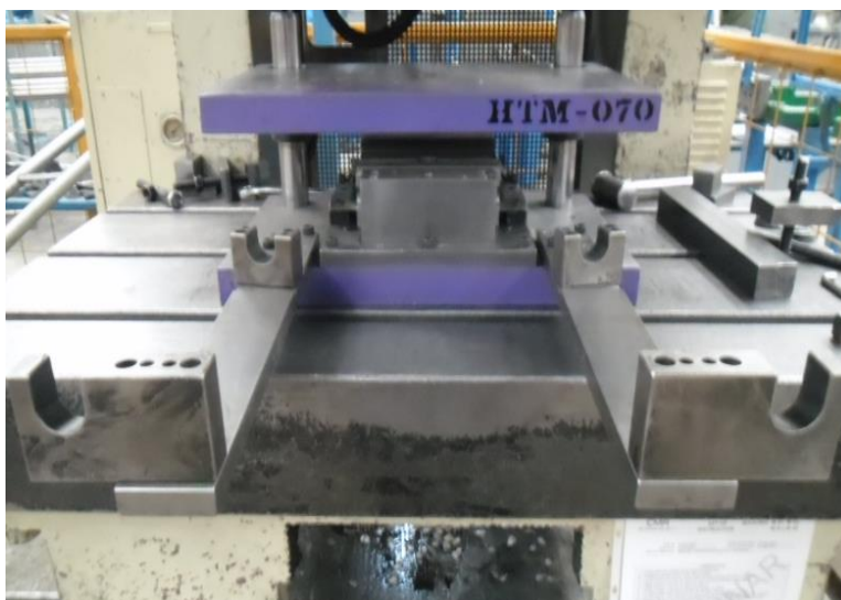
Figura 29 Troquel de punzonado terminado “Cortesía MEPEPSA/ATSA”.
