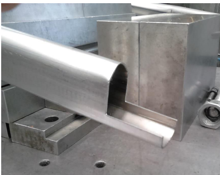
Figura 45 Corte de ventanas "Cortesía MEPEPSA/ATSA".
