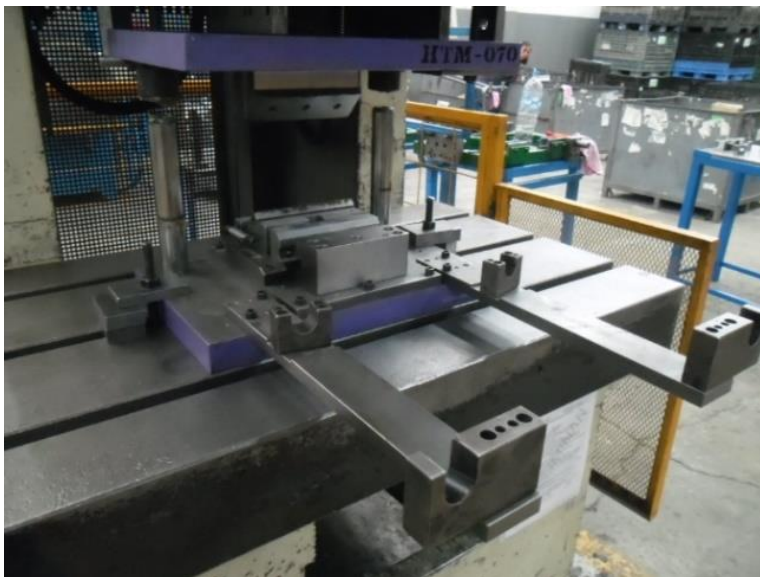
Figura 46 Troquel de punzonado “Cortesía MEPEPSA/ATSA”.
