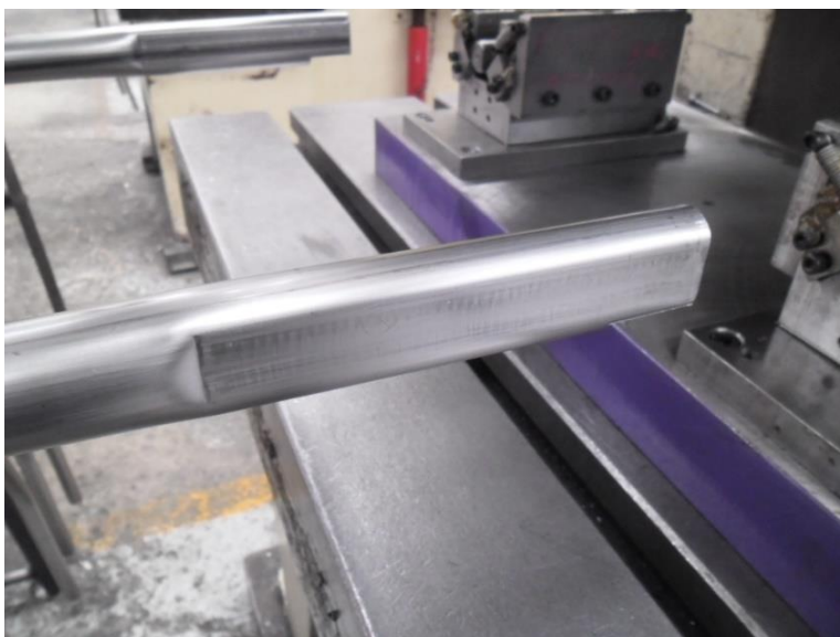
Figura 43 Estampado de extremos del tubo "Cortesía MEPEPSA/ATSA".
