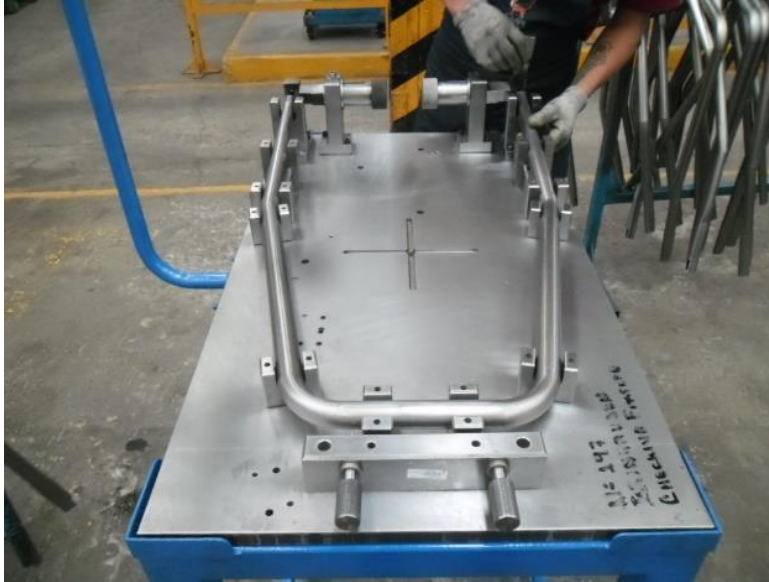
Figura 48 Comprobación de geometría "Cortesía MEPEPSA/ATSA".
