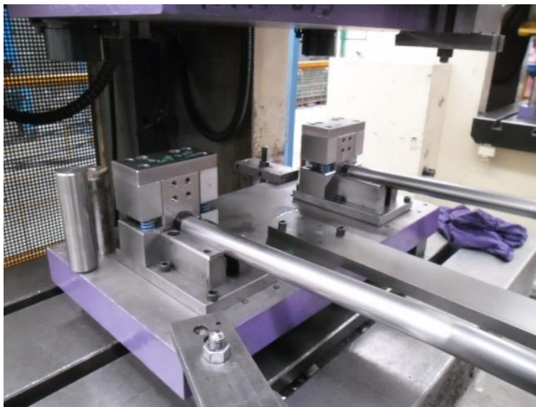
Figura 40 Operación de corte de puntas "Cortesía MEPEPSA/ATSA".
