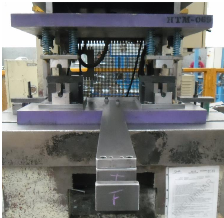
Figura 24 Troquel terminado “Cortesía MEPEPSA/ATSA”.
