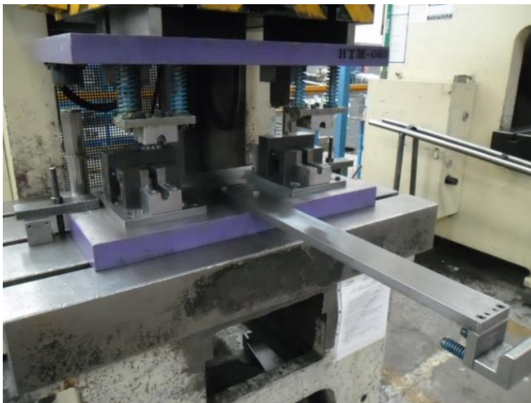
Figura 44 Operación de corte de ventanas "Cortesía MEPEPSA/ATSA".
