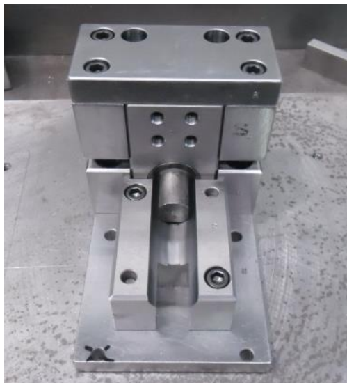
Figura 13 Armado de la estación de corte de punta “Cortesía MEPEPSA/ATSA”.
