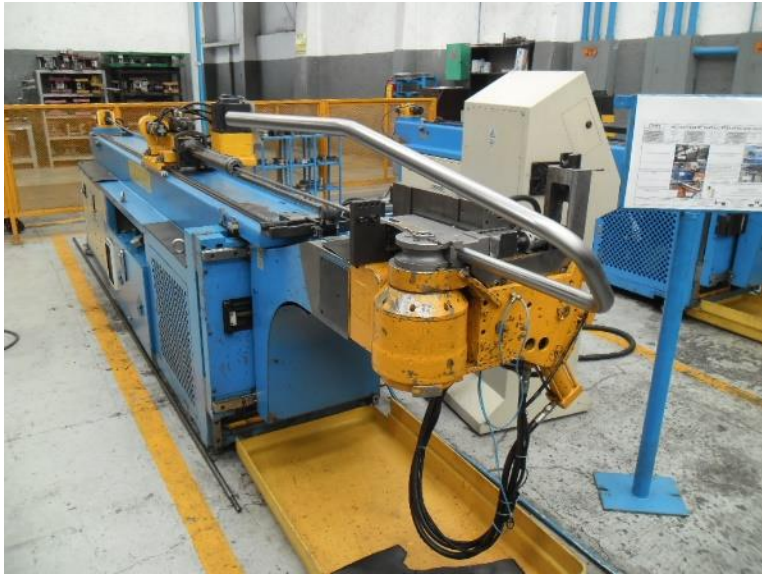
Figura 38 Proceso de doblez "Cortesía MEPEPSA/ATSA".
