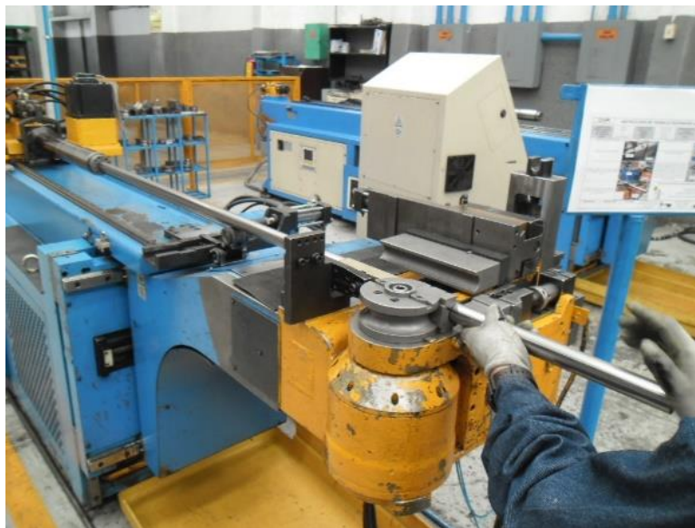
Figura 37 Colocación del tubo en dobladora CNC "Cortesía MEPEPSA/ATSA".
