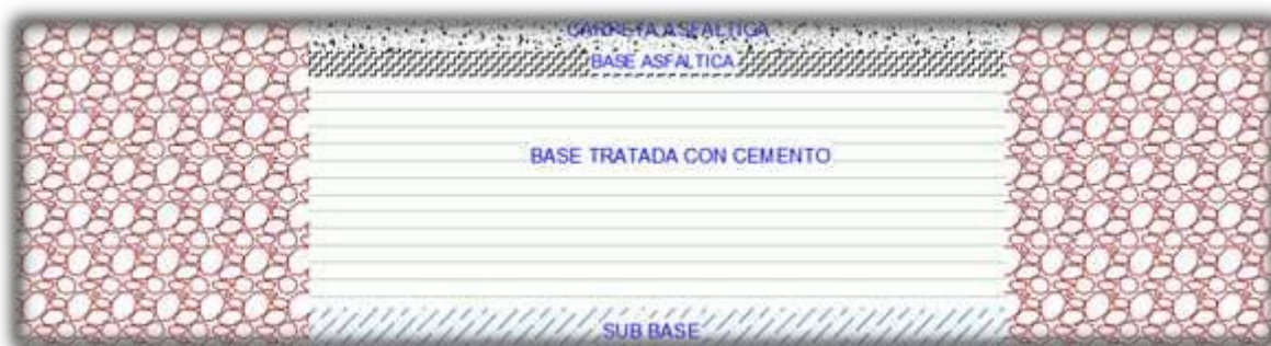
Figura 9 Capas de los pavimentos
