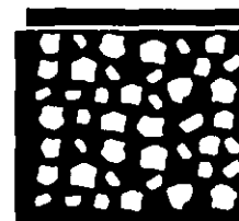
Recubrimiento con una delgada capa extendida en frío
