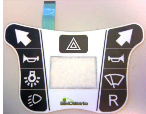
**Figura 88. Teclado del volante listo para instalar**
