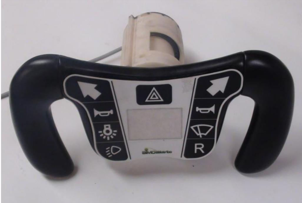
***Figura 77. Volante Extraíble con Controles al Mando para Vehículo Eléctrico.***
