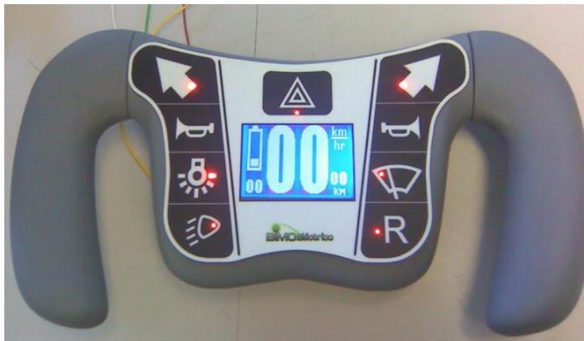
**Figura 89. Prototipo final funcional del volante**
