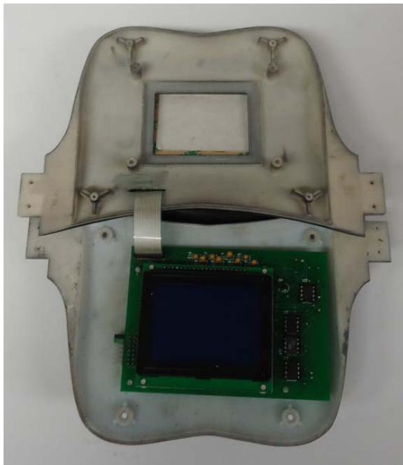
**Figura 62. Conexión de interfaz de usuario al MEGV.**
