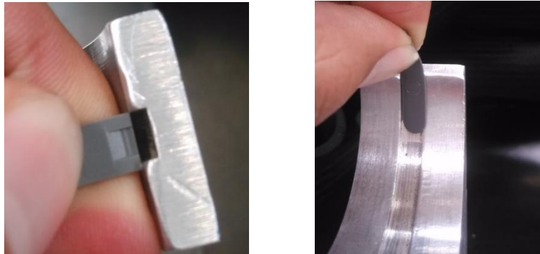
Figura 13.- Carril guía para la correa alrededor de la manguera
