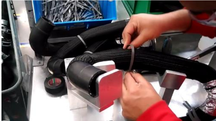
Figura 14.- Ajuste manual de la correa previo al uso de la pistola
