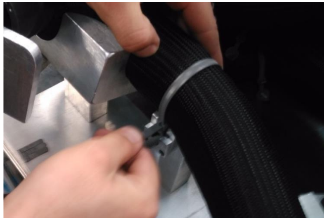
Figura 15.- La correa era tensada previamente sin restricción definida
