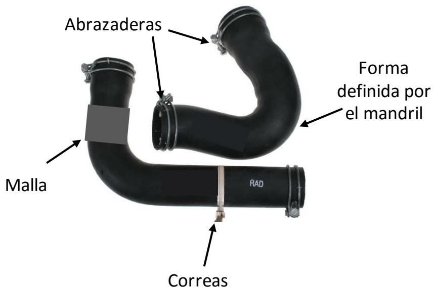
Figura 8: Mangueras del sistema de enfriamiento
