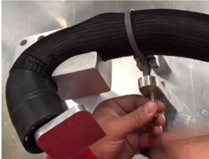
Figura 17.- Tope físico para limitar el avance de la correa
