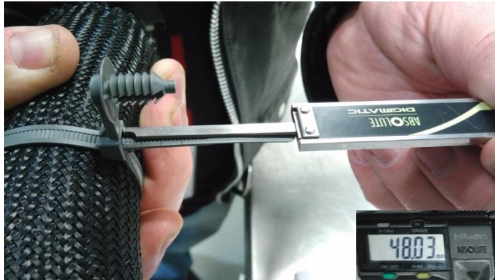
Figura 12. Medición de la longitud del sobrante de la correa
