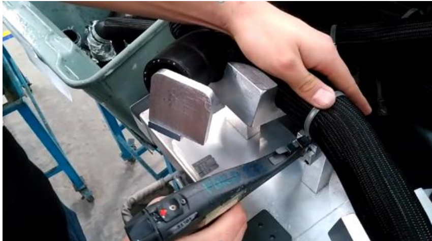
Figura 16.- Uso de la pistola para la tensión y corte de la correa
