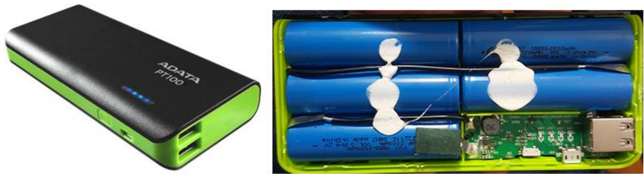
Figura 3.85. Powerbank de Adata modelo PT100 [488] y el contenido de su interior.
