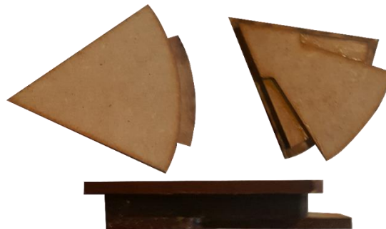
Figura 4.12. Piezas unidas para la tapa de la entrada del carrusel.
