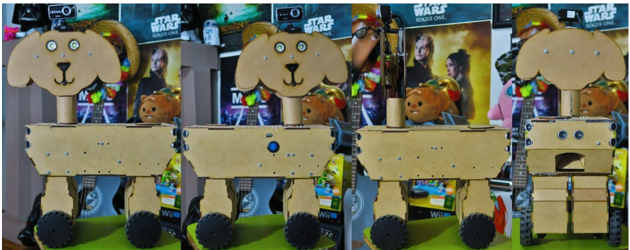
Figura 4.23. Diferentes vistas del chasis en forma de perrito del proyecto.
