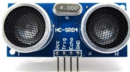
Figura 3.44. Sensor ultrasónico HC-SR04 [405]
