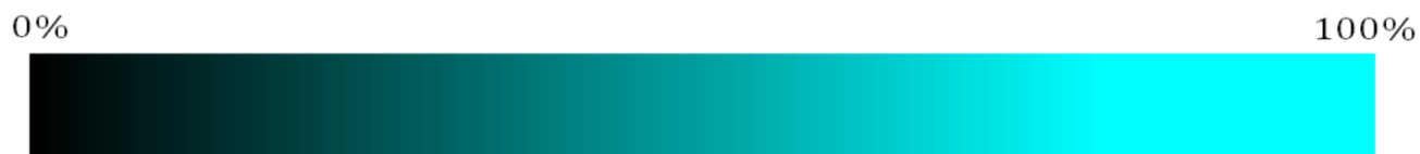
Figura 3.24. Valor o brillo en HSV para un tono 180 [°] con saturación de 100% [319].
