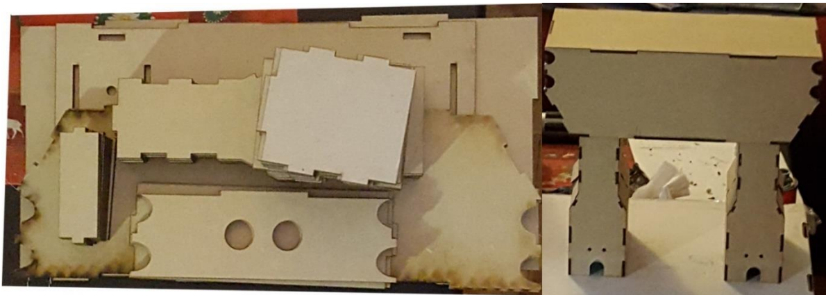
Figura 4.9. Piezas cortadas del chasis en MDF y su ensamble.
