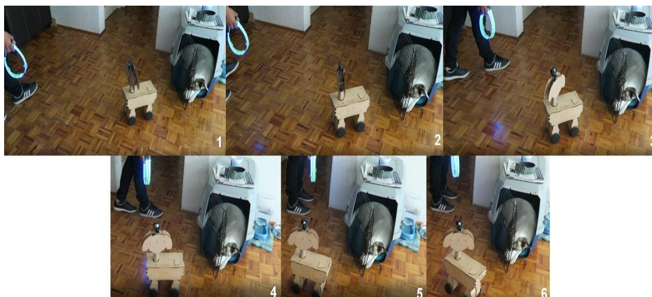
Figura 5.6. Giro del sistema y cambio de posicionamiento al seguir el collar hacia la derecha.
