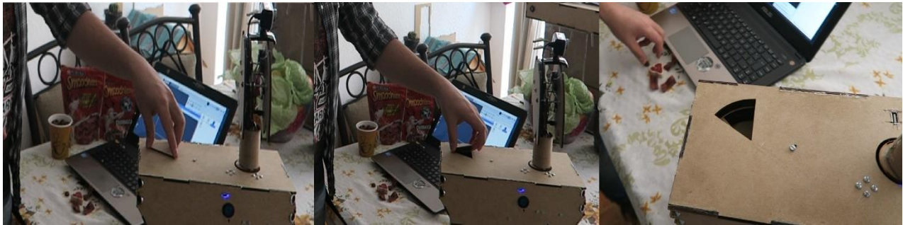
Figura 5.16. Apertura del sistema de dosificación para el depósito de premios.
