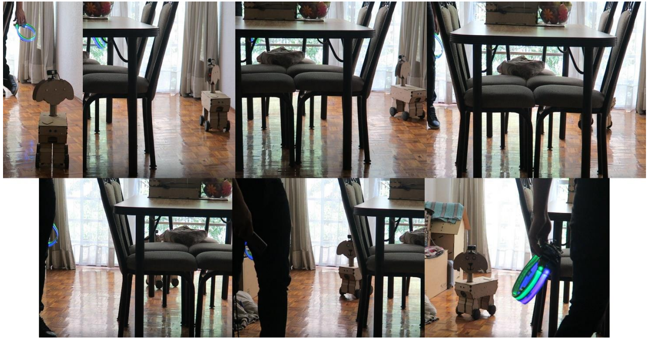
Figura 5.34. Seguimiento del collar en modo automático del sistema.
