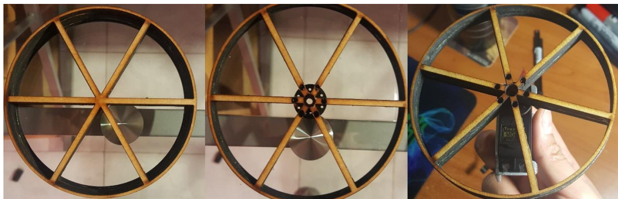
Figura 3.55 Elementos diseñados para las divisiones móviles del carrusel motorizado.
