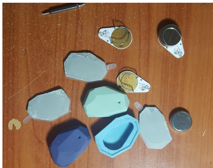
Figura 3.10. Beacons de la marca Estimote por adentro.
