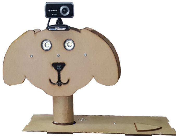
Figura 4.11. Tapa superior de torso, cuello y cabeza del sistema con elementos montados.
