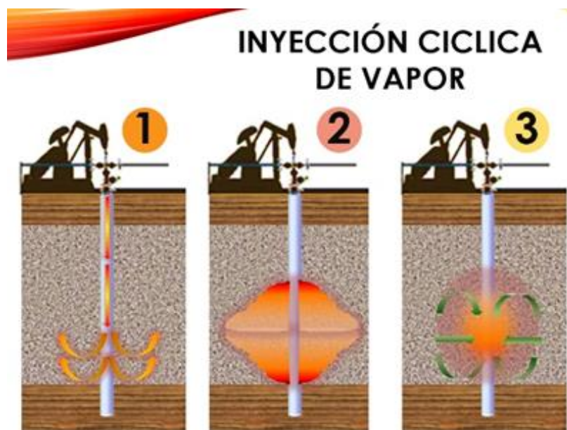
Figura 1.14 Proceso en Etapas de Inyección de Vapor Cíclica
