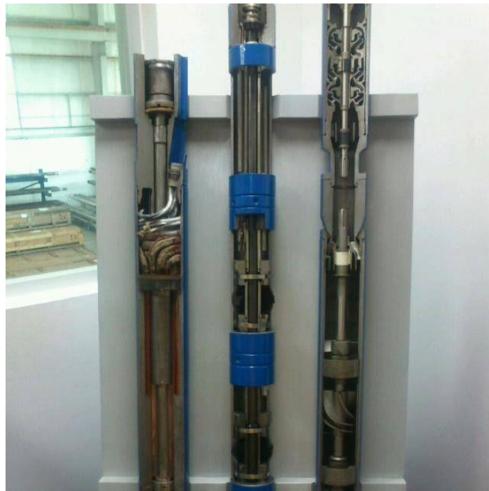
Figura 1.13 Componentes de Bombeo Electrocentrífugo
