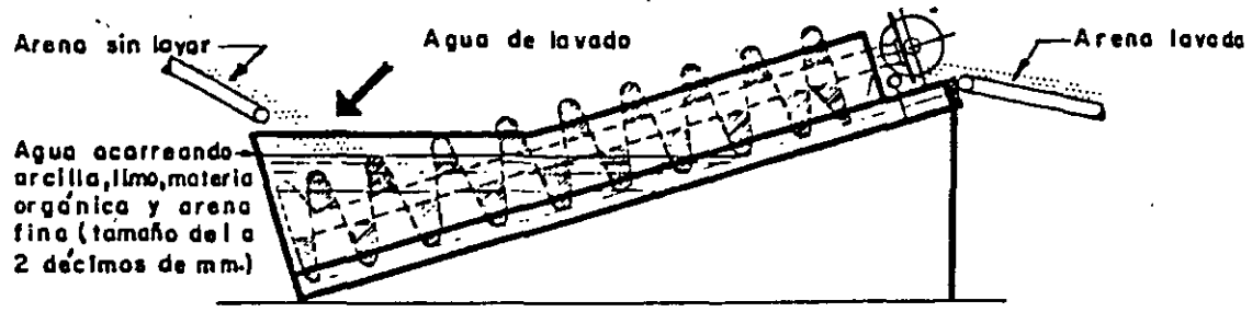
FIG. 42 CORTE ESQUEMATICO DE GUSANO LAVADOR
